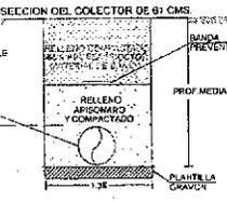
SECCION DEL COLECTOR DE 61 CMS
