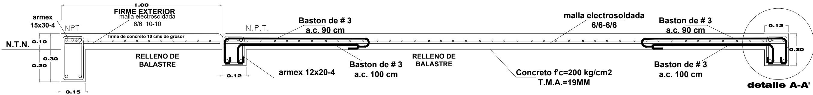
CORTE A-A' LONGITUDINAL EN CIMENTACIÓN
