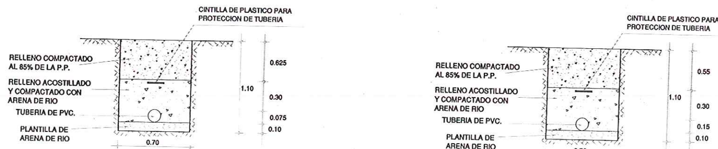
SECCION DE ZANJA TIPO EN TERRENO NATURAL
