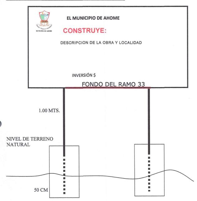
SEÑALAMIENTO A BASE DE VINIL APLICADO A PANTALLA LAMINADA CON DIMENSIÓN DE 1.20 X 0.90 MTS., CON ESTRUCTURA DE P.T.R. DE 1 ½" MARCO Y 2 PATAS, PANTALLA CON LAMINA GALVANIZADA CAL. 26 Y FONDO DE PANTALLA CON ESMALTE BLANCO.
