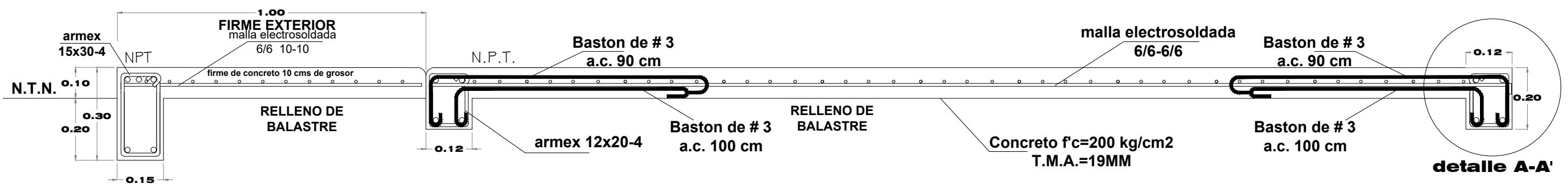
CORTE A-A' LONGITUDINAL EN CIMENTACIÓN
