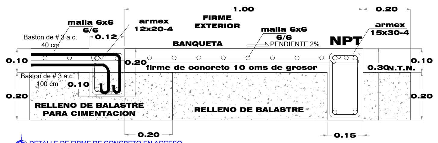
DETALLE DE FIRME DE CONCRETO EN ACCESO
