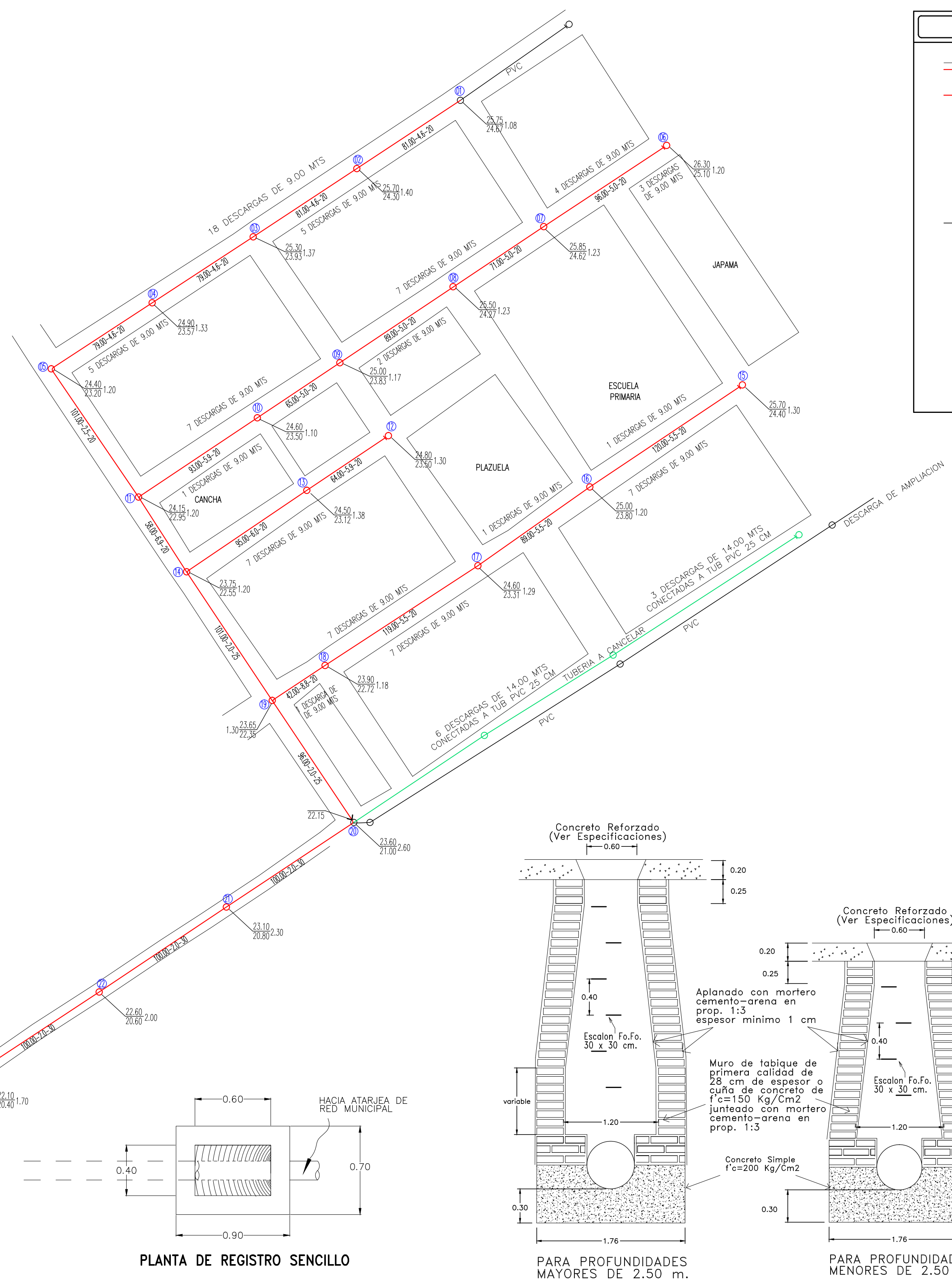
DETALLE DE POZO DE VISITA "COMUN" CON TUBERIA DE P.V.C.
