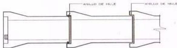
TUBERÍA DE HIERRO DUCTIL
