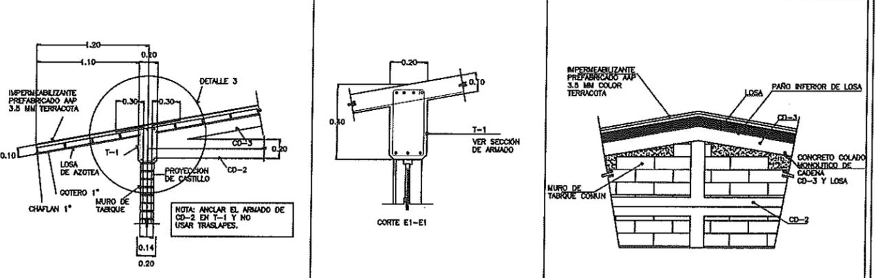
CORTE E-E CORTE 3 DETALLE DE MURO CABECERO
