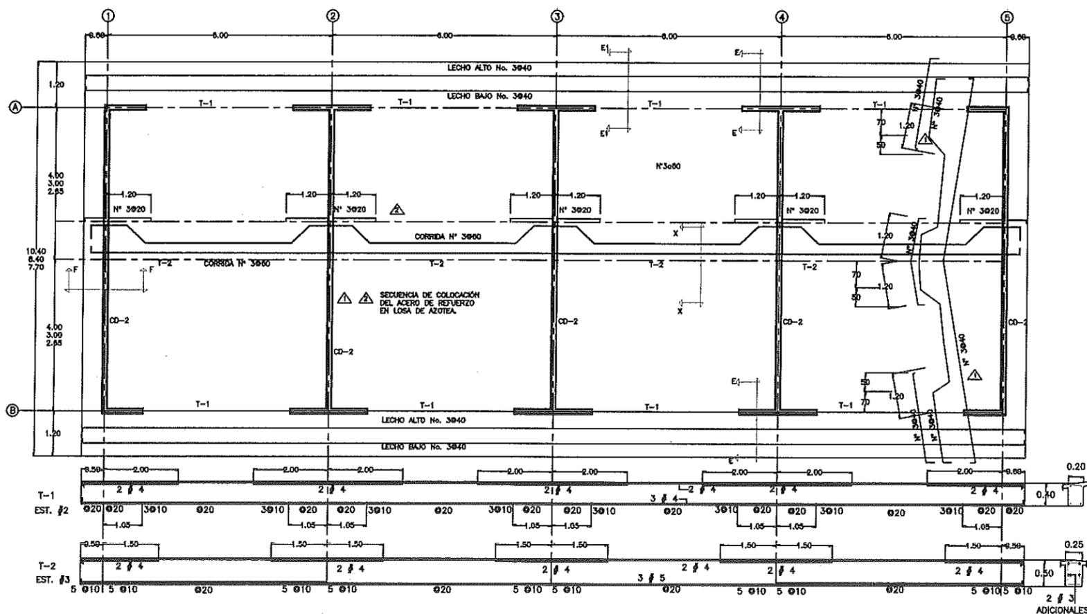
PLANTA DE ARMADO DE LOSA (AGRPAMIENTO MAXIMO 4 AULAS) ESC. 1:125
