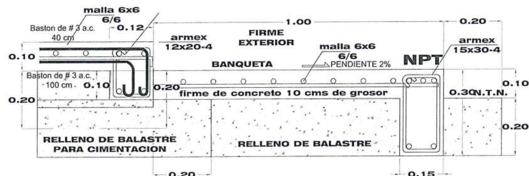
DETALLE DE FIRME DE CONCRETO EN ACCESO
