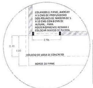
PLANTA DETALLE DE PREPARACION PARA ANCLAJE DE PUERTA
