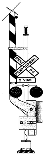
FIGURA 1 Semáforo SEM-4.6 A
